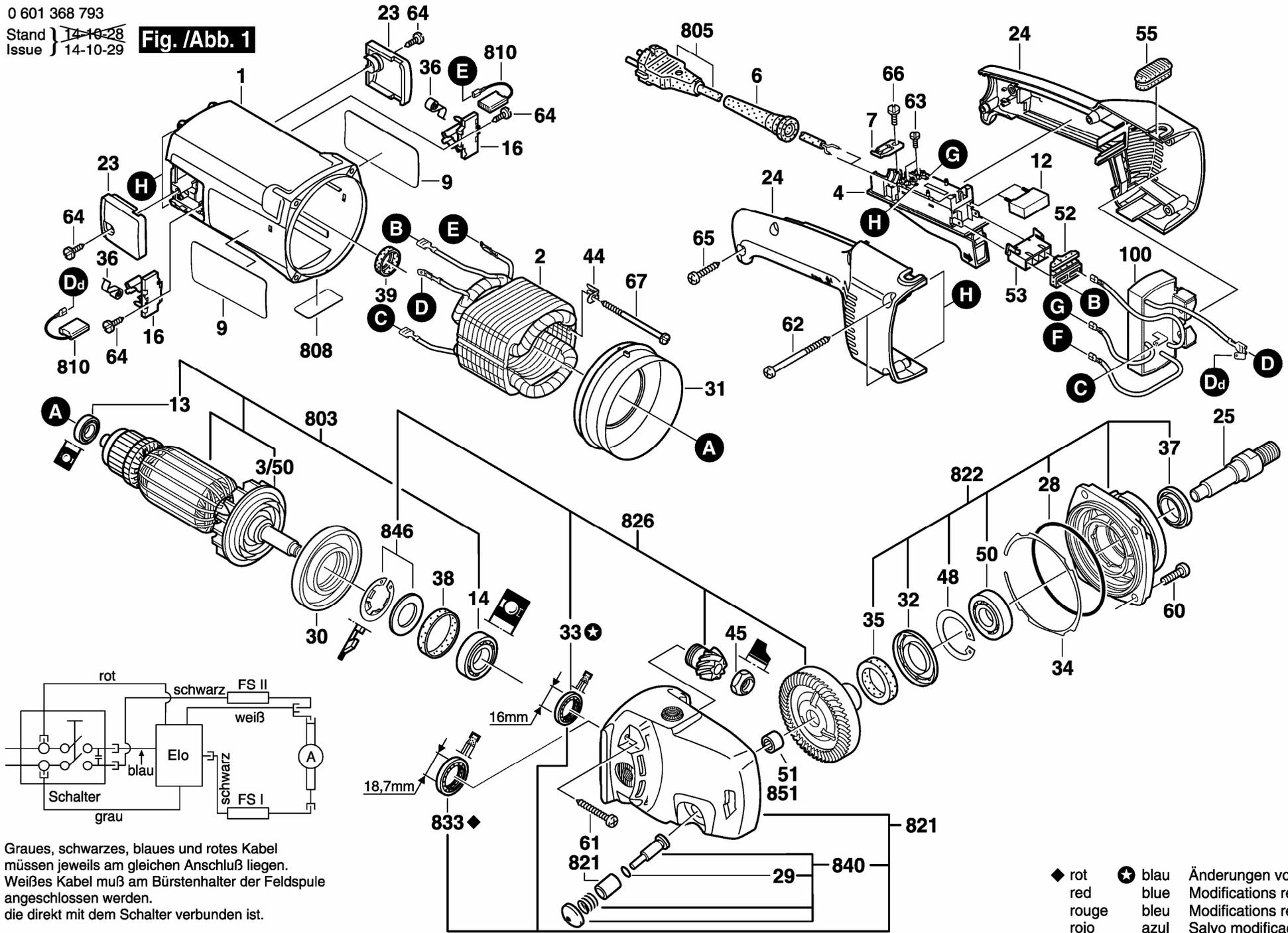
Graues, schwarzes, blaues und rotes Kabel müssen jeweils am gleichen Anschluß liegen. Weißes Kabel muß am Bürstenhalter der Feldspule angeschlossen werden. die direkt mit dem Schalter verbunden ist.
